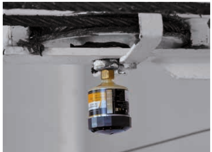
救生艇应用: - 滚动轴承 - 滑轮轴承 润滑系统: Klübermatic FLEX 60 cm 3
