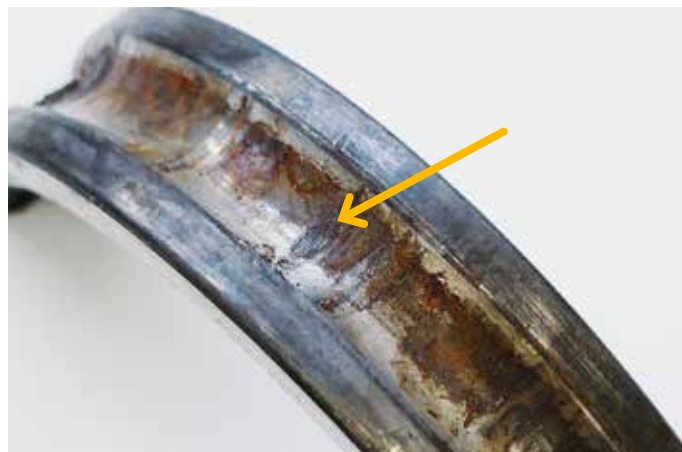
Verschleißmarken, verursacht durch Vibration im Stillstand – False Brinelling genannt
