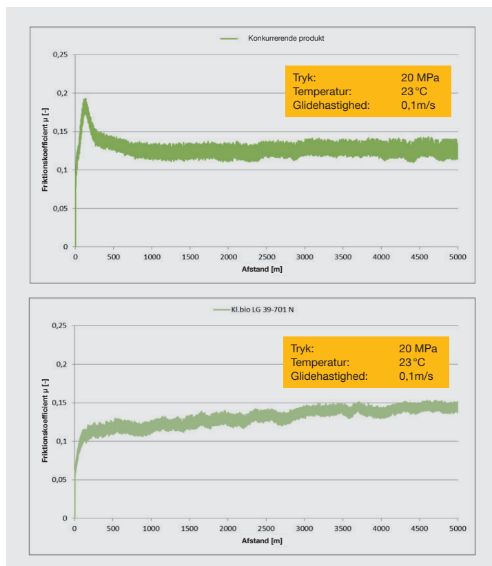
Diagram 2: Oscillationsfriktionslindtribometer (SRV) kørt med Klüberbio LG 39-701 N og et biologisk nedbrydeligt konkurrerende produkt.
