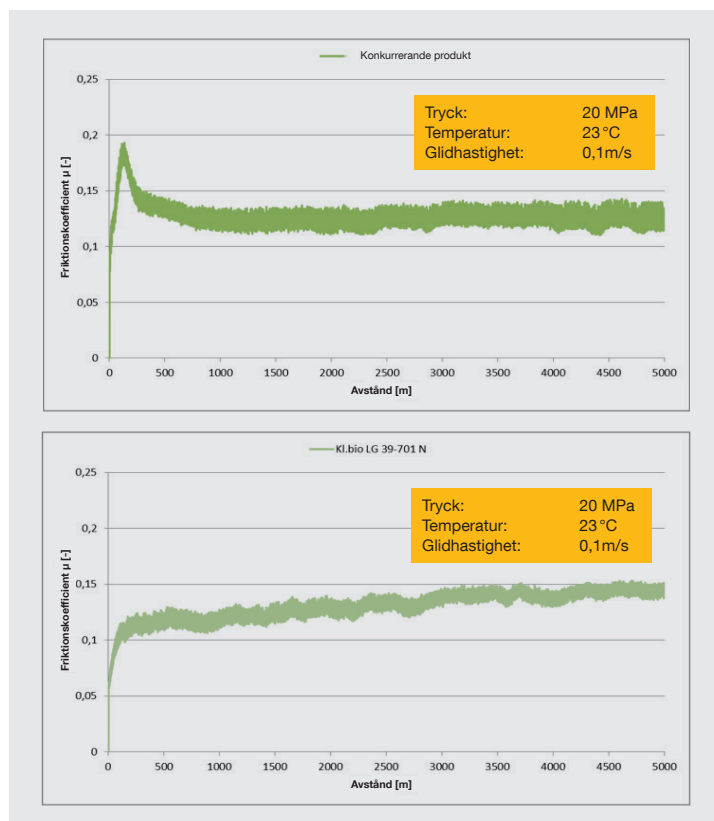
Diagram 2: Oscillerande tribometer för friktionsslitage (SRV) som körts med Klüberbio LG 39-701 N och en biologiskt nedbrytbar konkurrerande produkt.
